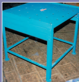
Стол с механически выдвигающимися шариковыми опорами для перемещения груза (для фиксации груза опоры опускаются).
