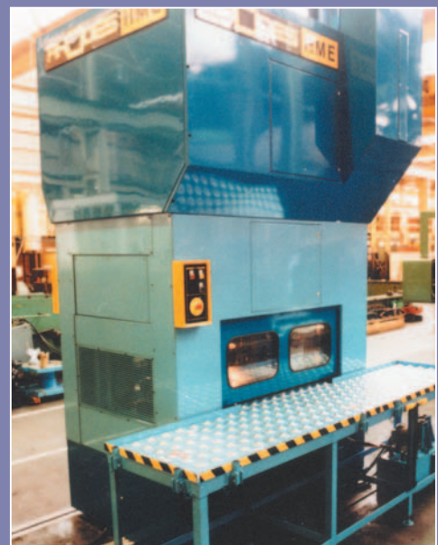
Стол перед прессом для быстрой замены оснастки (пресс-форм).
