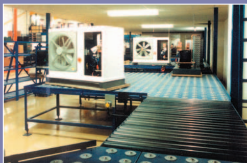
Шариковые столы как часть монтажной линии.
