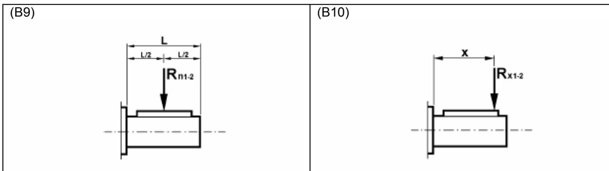
а) **Нагрузка, приложенная к срединной точке хвостовика вала (рис. (B9))**
