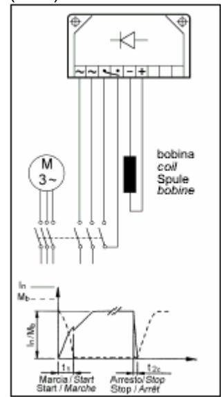
bobina / coil / Spule / bobine - катушка
