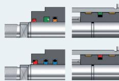
Безопасность работы благодаря саморегулирующемуся или регулируемому демпфированию в конце хода
