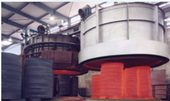
Колпаковая установка для отжига с тремя рабочими станциями
