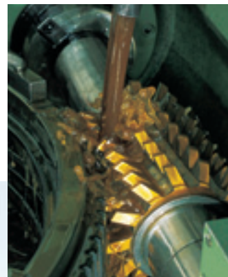
Изготовление зубчатого зацепления при помощи червячных фрез
